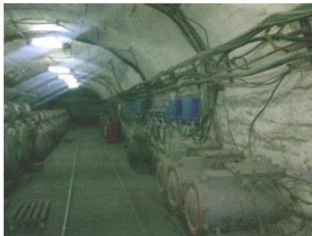
Рисунок 1.8 - Оптиковолокнінні лінії та лінії мобільного зв'язку в штрєці шахти на шляху до водовідливної установки
